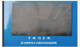
石墨烯基环氧锌粉重防腐涂料涂覆于Q235钢
