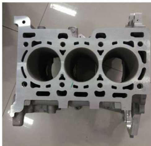
发动机汽缸内壁涂层技术：在缸孔内壁直接喷涂一层纳米级的耐磨涂层，可替代原先的缸套或进行汽缸的再制造修复，摩擦损失降低50%，降低油耗3-5%，大幅提高发动机使用寿命及减少排放。
